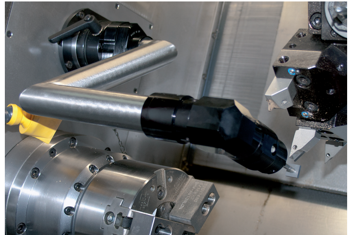
Bras amovible RENISHAW pour mesures d'outils Absetzbares Werkzeugmesssystem RENISHAW Removable RENISHAW tools measuring system
